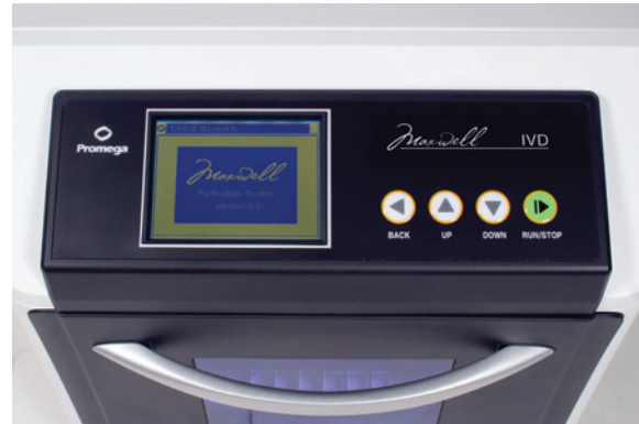
Figur 3. Pekskrmen och knappsatsen används för att navigera genom de olika skärmarna för Maxwell® 16 IVD Instrument. Samma knappval finns på både knappsatsen och skärmen. Båda knappsatserna kan användas för att navigera inom och mellan skärmarna. Back- och Run/Stop-knapparna används för att navigera mellan skärmarna. Up- och Down-knapparna används för att navigera inom en skärm.
